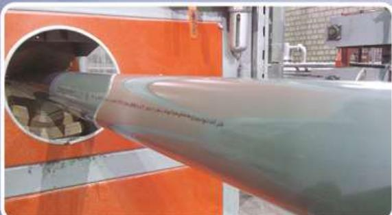
لوله های U-PVC عبور سیم و کابل های داخل ساختمان و تاسیسات الکتریکی: خاصیت اصلی این لوله ها علاوه بر تحمل ضربه مقاومت در برابر آتش می باشد. در تولید لوله های عبور کابل، ۹۰ الی ۹۵ درصد مواد را پودر پلیمری U-PVC تشکیل می دهد و به راحتی تا بیش از ۹۰ درجه خم می شوند
